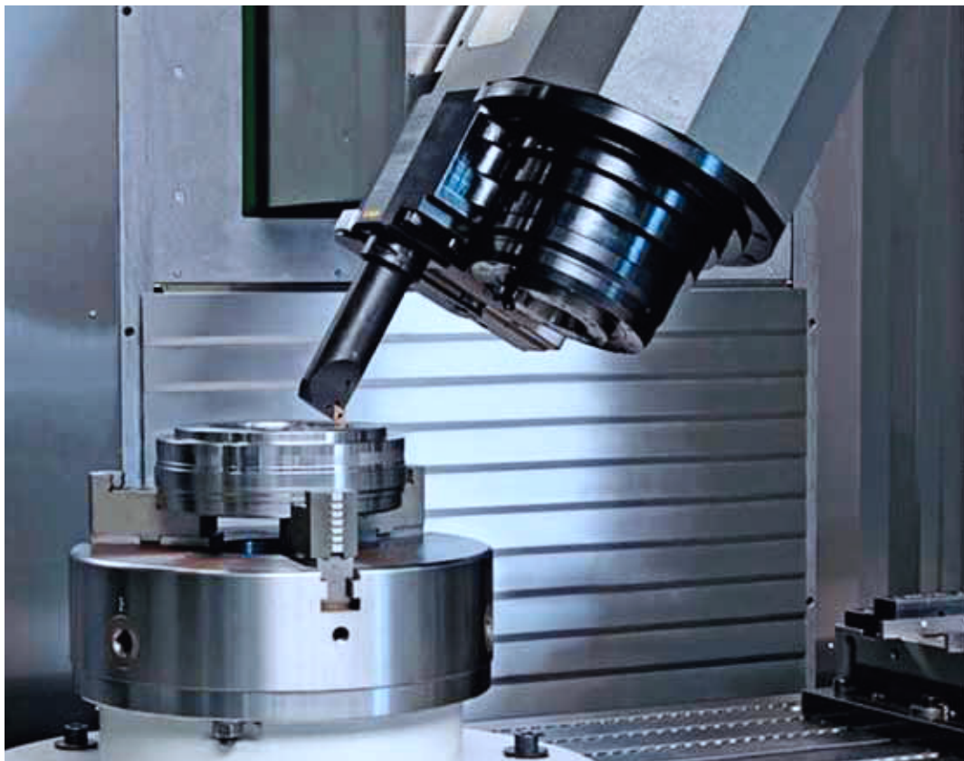
Frézování, vrtání a soustružení na obráběcím centru AXA - vedle vertikální a horizontální polohy jsou nastavitelné všechny úhly mezi jmenovanými krajními polohami
